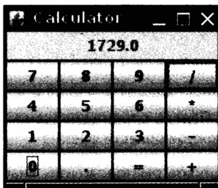
Рис. 9.12. Сеточная компоновка кнопок калькулятора
