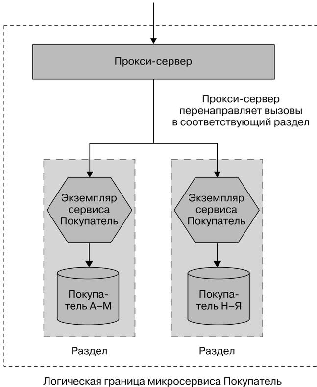
**Рис. 13.5.** Запросы направляются в соответствующий экземпляр микросервиса
